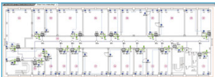
nanoCAD ОПС. План этажа здания с оборудованием
